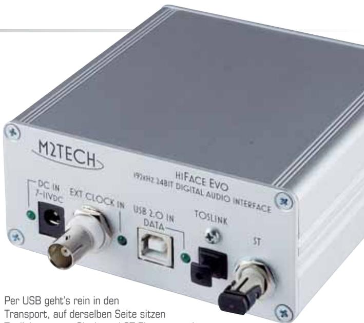
Per USB geht's rein in den Transport, auf derselben Seite sitzen Toslinkausgang, Clock- und ST-Eingang sowie der Stromanschluss
